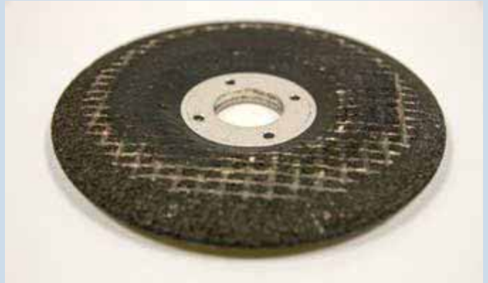
Nepravilno korišćena brusna ploča (napadni ugao je suviše mali)
